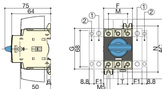
1. Emplacement pour: 1 pôle principal (maximum 1 par appareil) **ou** 1 pôle neutre **ou** 1 pôle PE **ou** 1 contact auxiliaire.
