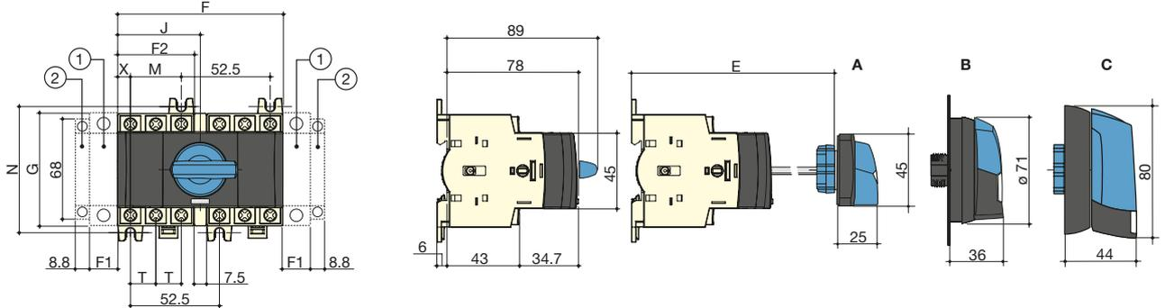
1. Emplacement pour: 1 pôle principal (maximum 1 par appareil) **ou** 1 pôle neutre **ou** 1 pôle PE **ou** 1 contact auxiliaire.
