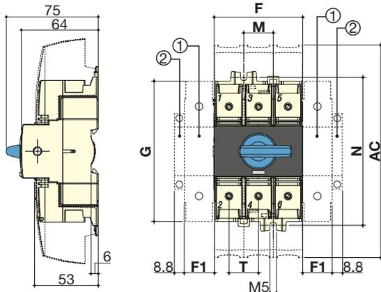
1. Emplacement pour: 1 pôle principal (maximum 1 par appareil) **ou** 1 pôle neutre **ou** 1 pôle PE **ou** 1 contact auxiliaire.
