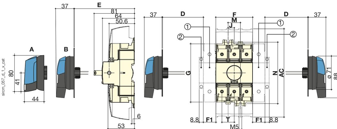
1. Emplacement pour: 1 pôle principal (maximum 1 par appareil) **ou** 1 pôle neutre **ou** 1 pôle PE **ou** 1 contact auxiliaire.
