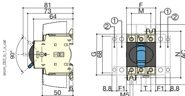
1. Emplacement pour: 1 pôle principal (maximum 1 par appareil) **ou** 1 pôle neutre **ou** 1 pôle PE **ou** 1 contact auxiliaire.
